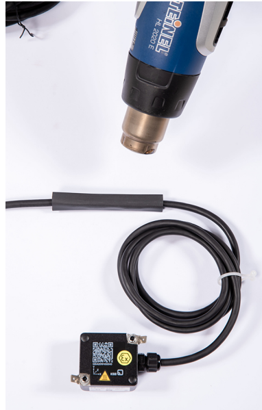
Fig. 12: Calentamiento de la funda retráctil
