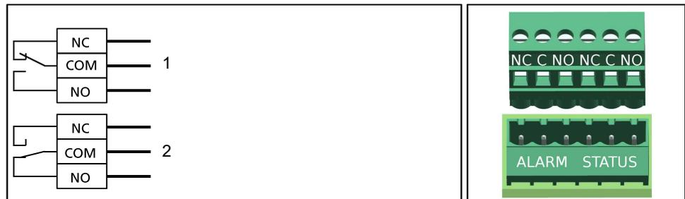
**Fig. 10:** Plano de conexiones eléctricas del mensaje de error acumulativo
