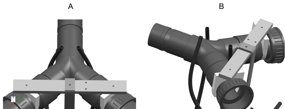
Fig. 42: Tendido de los cables eléctricos de los interruptores flotadores
