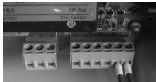
Fig. 17: Conexión de la alarma externa
