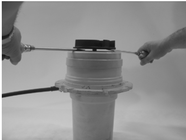
Fig. 27: Desmontaje del rodete
