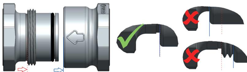
**Fig. 20:** Comprobar la alineación
