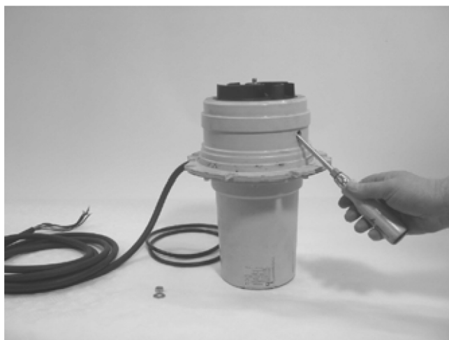
Fig. 25: Desmontaje del rodete
