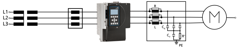
Fig. 31: Montaje del estrangulador de red y del filtro de salida
