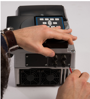
Fig. 43: Fijación del módulo M12
