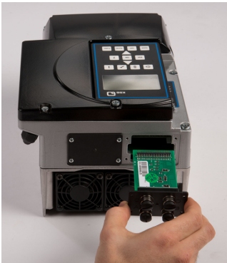
Fig. 35: Inserción del módulo M12
