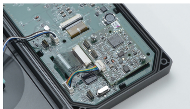
Fig. 50: Fijación del módulo Bluetooth
