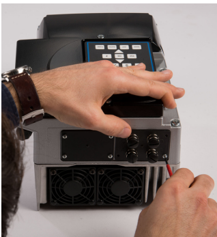
Fig. 36: Fijación del módulo M12
