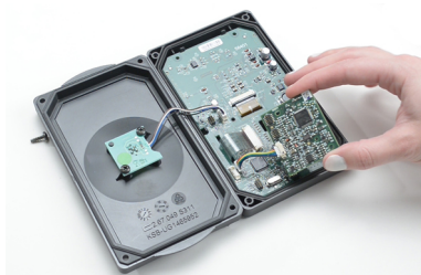
Fig. 49: Montaje del módulo Bluetooth
