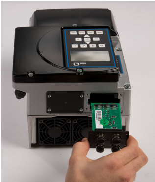
Fig. 42: Introducción del módulo del bus de campo
