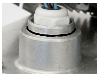
Fig. 28: Colocación de la junta tórica
