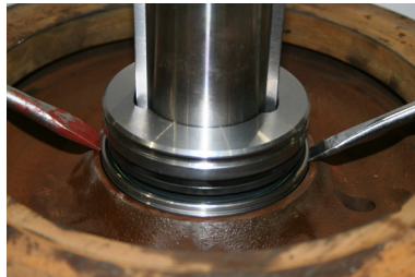
Fig. 10: Fijación de cierres mecánicos con palancas de hierro.
