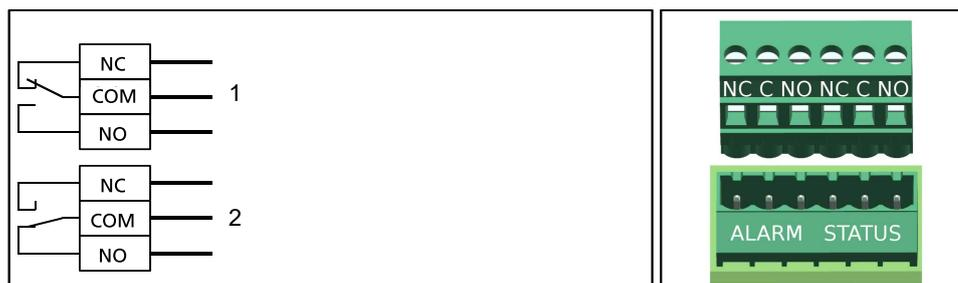
Fig. 11: Plano de conexiones eléctricas del mensaje de error acumulativo
