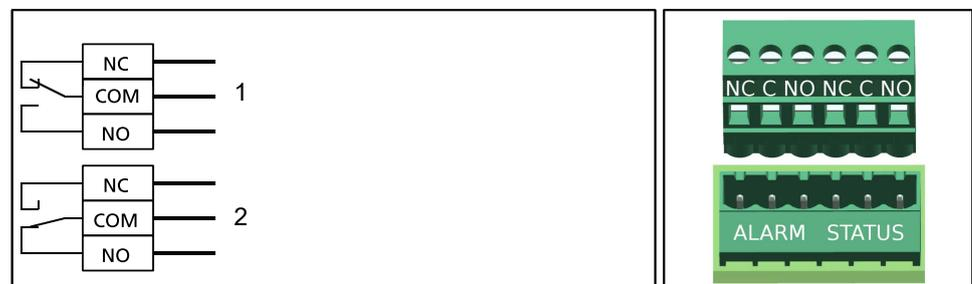
Fig. 10: Plano de conexiones eléctricas del mensaje de funcionamiento
