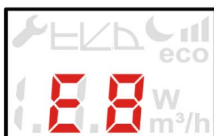
Fig. 16: Indicación de mensaje de error E8 (error del motor)
