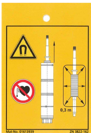
Fig. 2: Adhesivo de advertencia que debe pegarse en el motor en caso de devolución.
